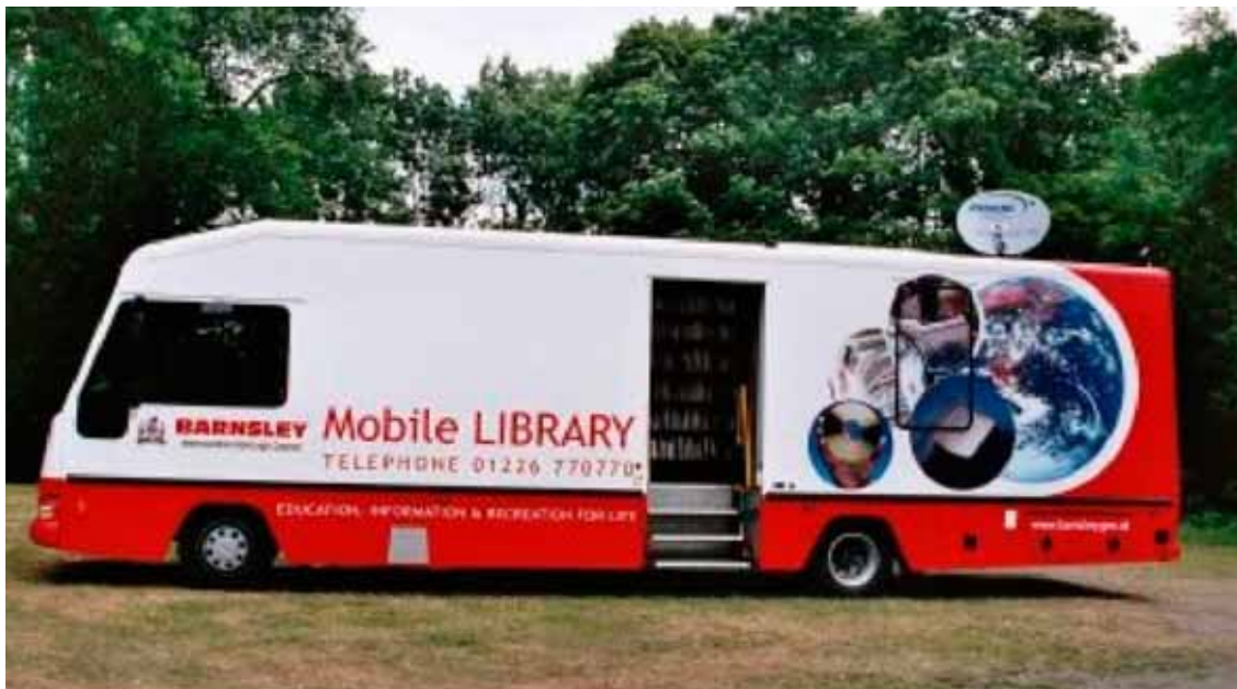
11. Мобильная библиотека из г. Барнсли (Великобритания). При въезде в низкий гараж спутниковая тарелка может утапливаться в крышу.
