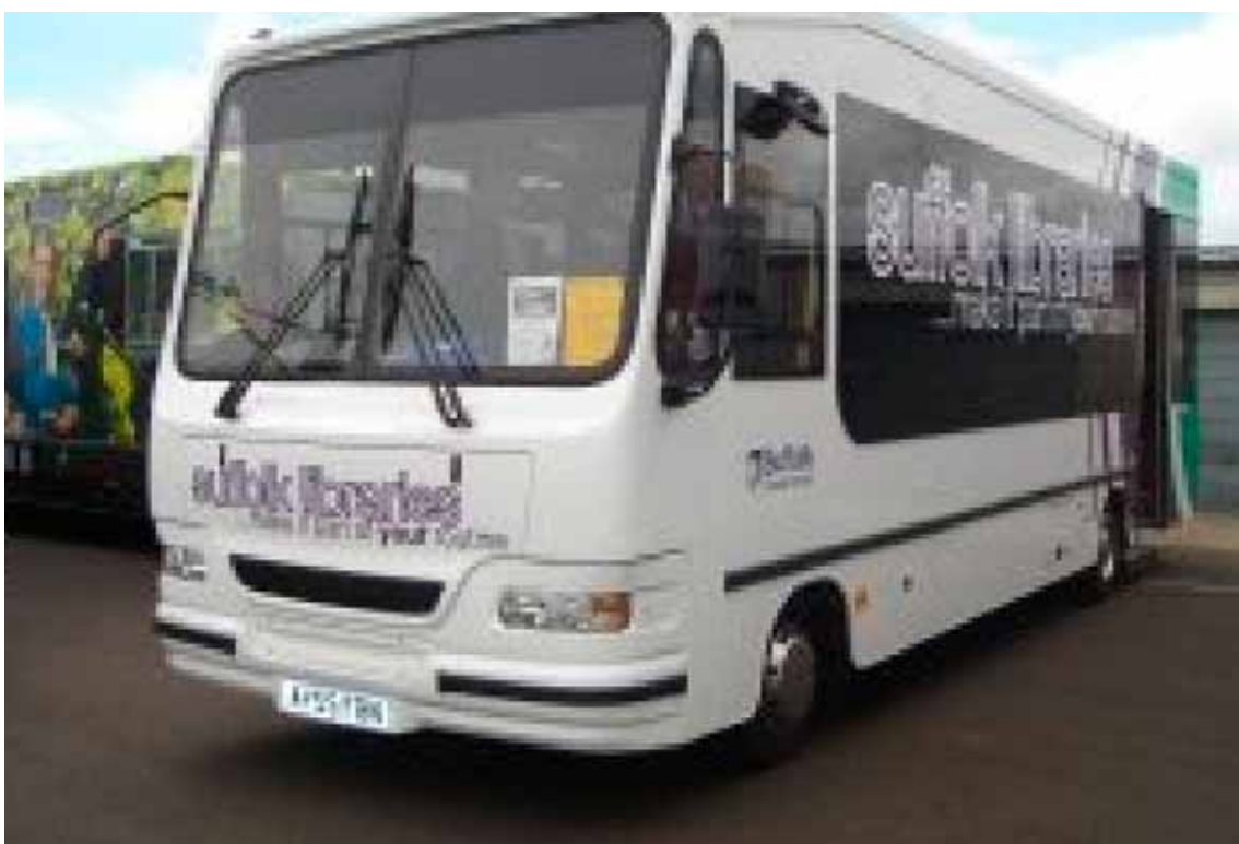
18. Чтобы максимально использовать естественный свет, целый борт сделан из сплошного стекла (графство Саффолк, Великобритания).
