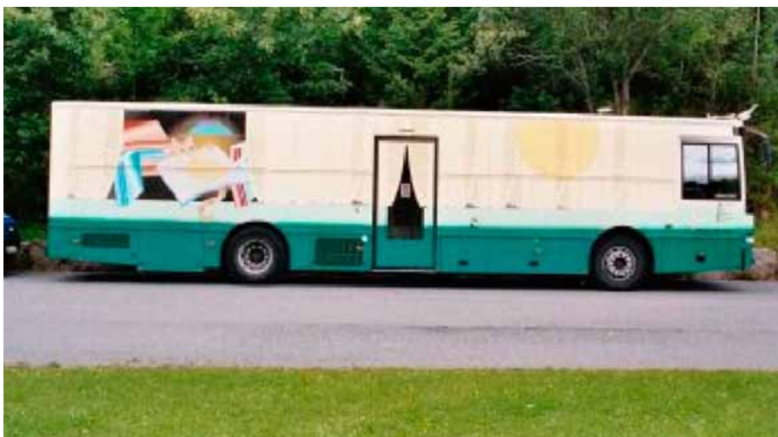
16. Мобильная библиотека из Норвегии. Видны длинные нависающие передняя и задняя части.
