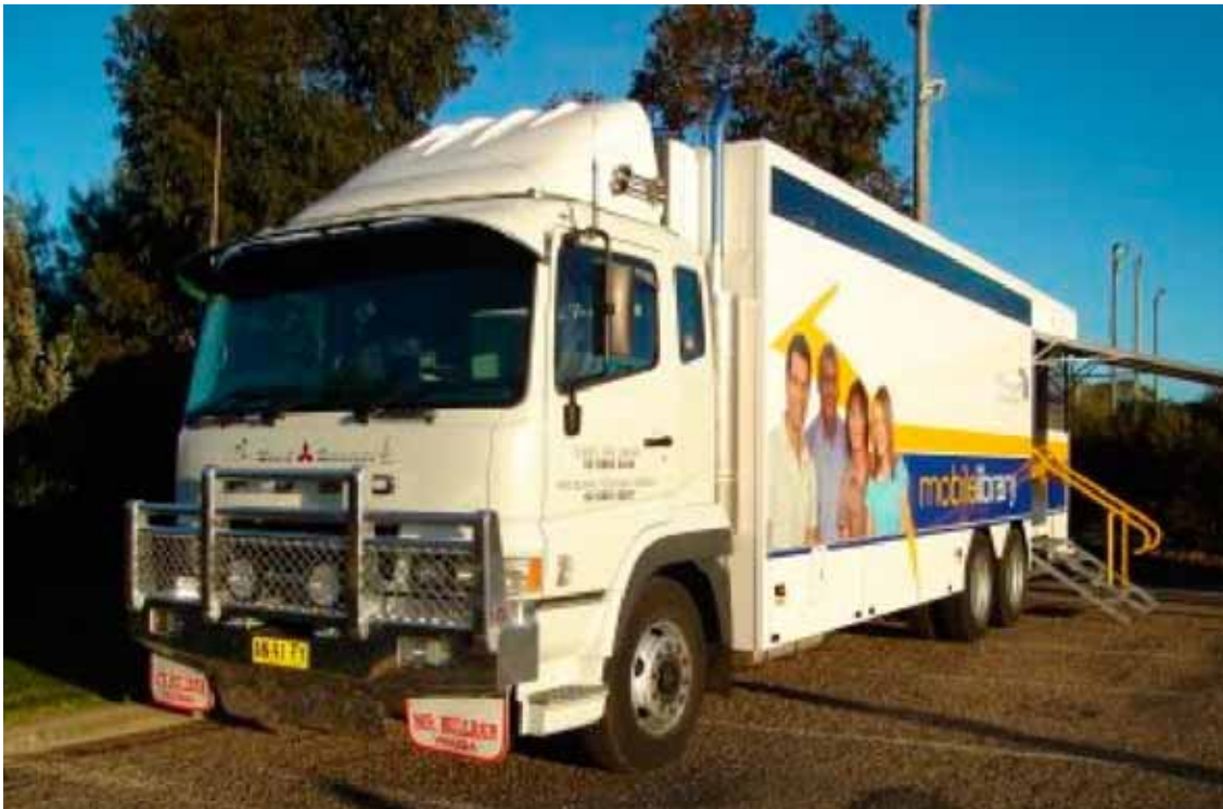
36. Австралийская мобильная библиотека (шт. Новый Южный Уэльс). Для этого автофургона, совершающего поездки до 450 км во внутренние малонаселенные районы страны, характерны прочная конструкция и решетка из труб, защищающая от столкновения с крупными животными.
