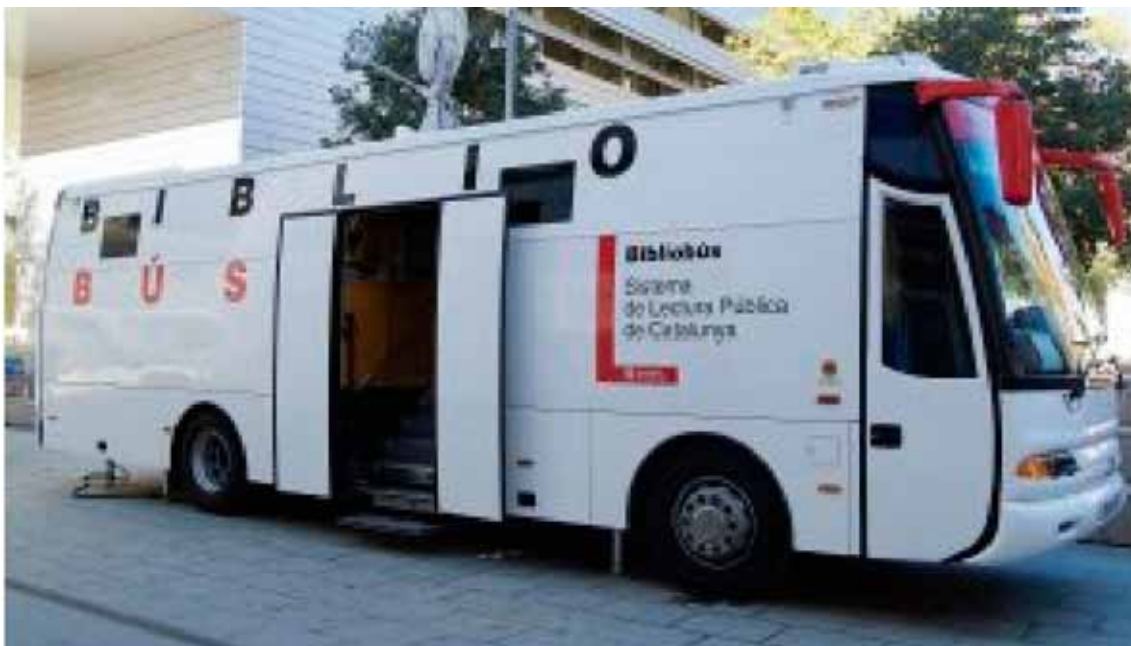
17. Барселона (Испания). Обратите внимание на прислонно-сдвижные двери и обогреваемые зеркала заднего вида.
