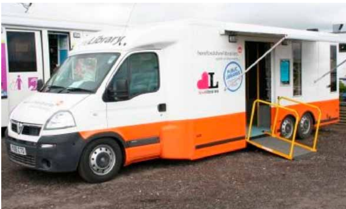
6. Небольшая трехосная мобильная библиотека из г. Бексли (Великобритания). На снимках видны низко расположенная дверь и небольшой трап.
