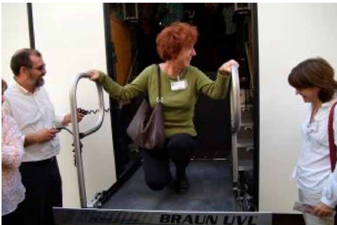
20. Подъемник для въезда инвалидных колясок (Барселона, Испания).
