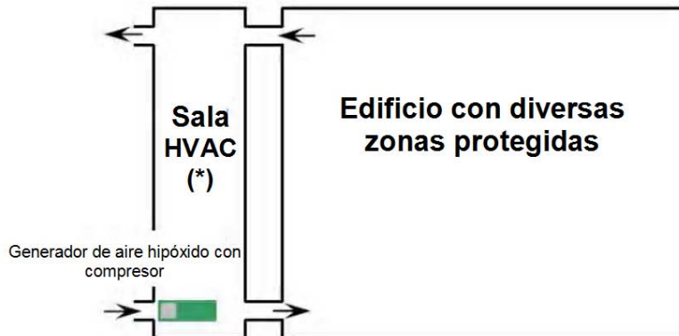
Prevención y extinción de incendios mediante ventilación con aire hipóxido
